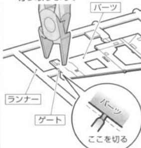
②ニッパーの刃をパートに密着させてゲートを切り取れば、
